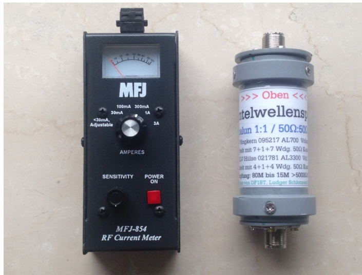
Zangenamperemeter und Mantelwellensperre (Strom-Balun)
